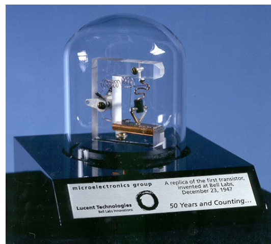
Figura 3: Réplica do Primeiro Transistor, Bell Labs, 1947.
